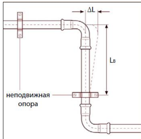
Рис. 12. Z-подібний компенсатор лінійних подовжень.
