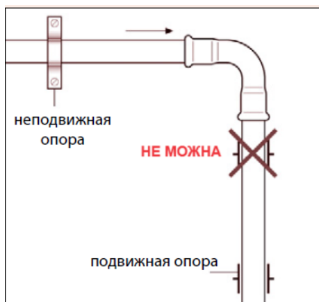
Рис. 16. Фіксування трубопроводу: нерухома опора поруч зі з'єднанням: не вірно!
