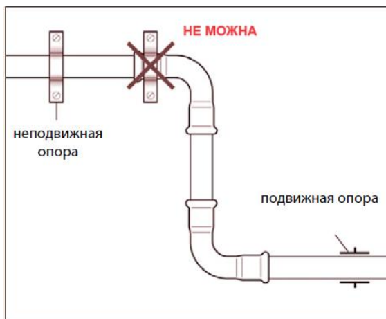
Рис. 17. Фіксування трубопроводу: нерухома опора на фітінгу: не вірно!
