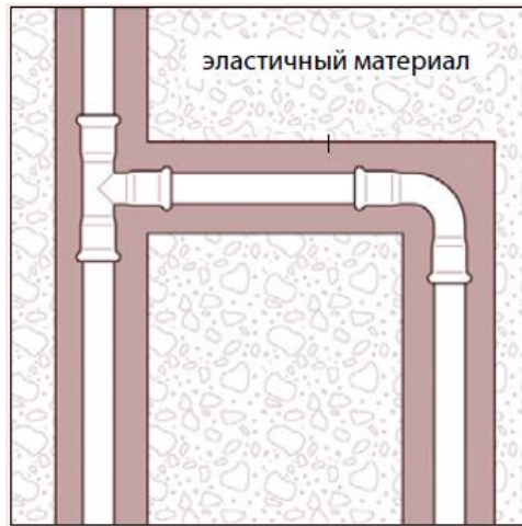
Рис. 7. Скрите прокладання трубопроводу
