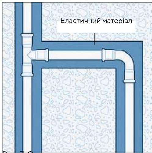
Рис. 7. Скрите прокладання трубопроводу
