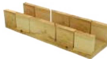
Малюнок 4. Дерев'яне стушло: ширина паза = DN, висота = DN+50мм.
