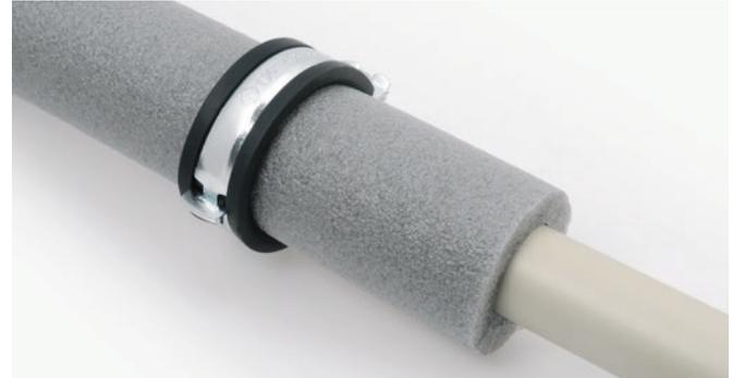
Для транспортування гарячої води хомут кріпиться через ізоляцію – на розмір більше
